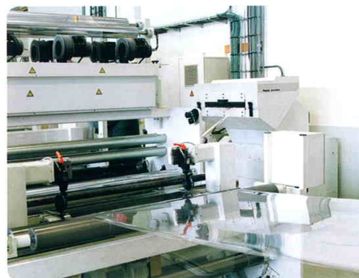
Broyage en ligne de chutes de lisières avec alimentateur à rouleaux spécialisé.
