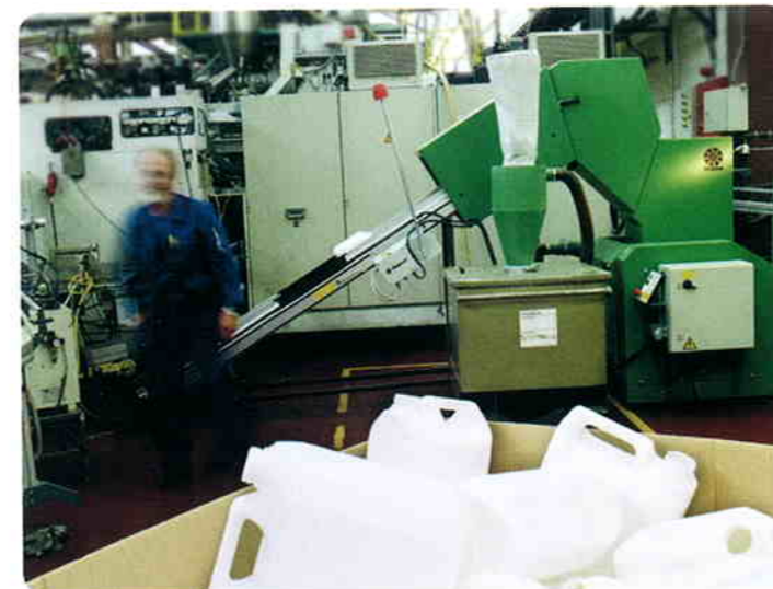
Broyeur en configuration-type pour application du soufflage
