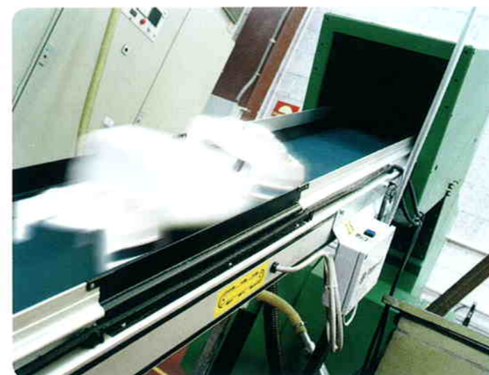
Tapis convoyeur et tunnel insonorisé pour un broyage plus silencieux.
